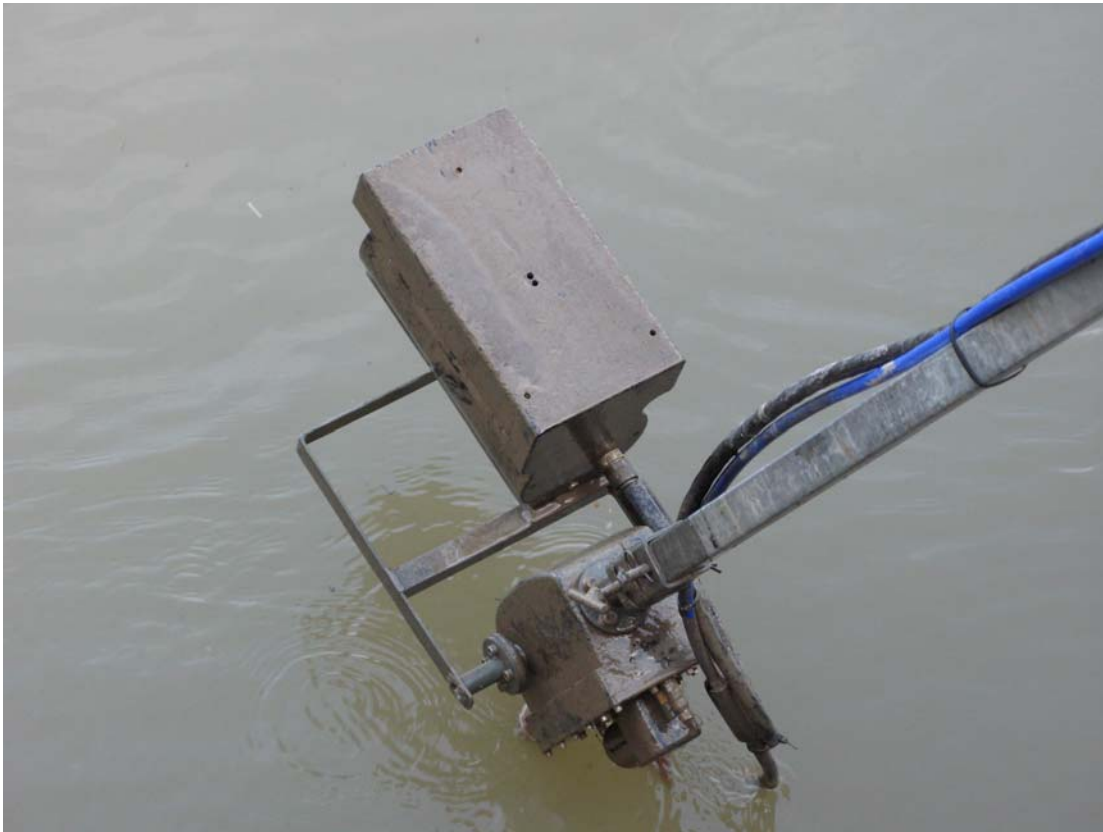
Abb. 1: DIDSON-Sonar im Feldeinsatz
